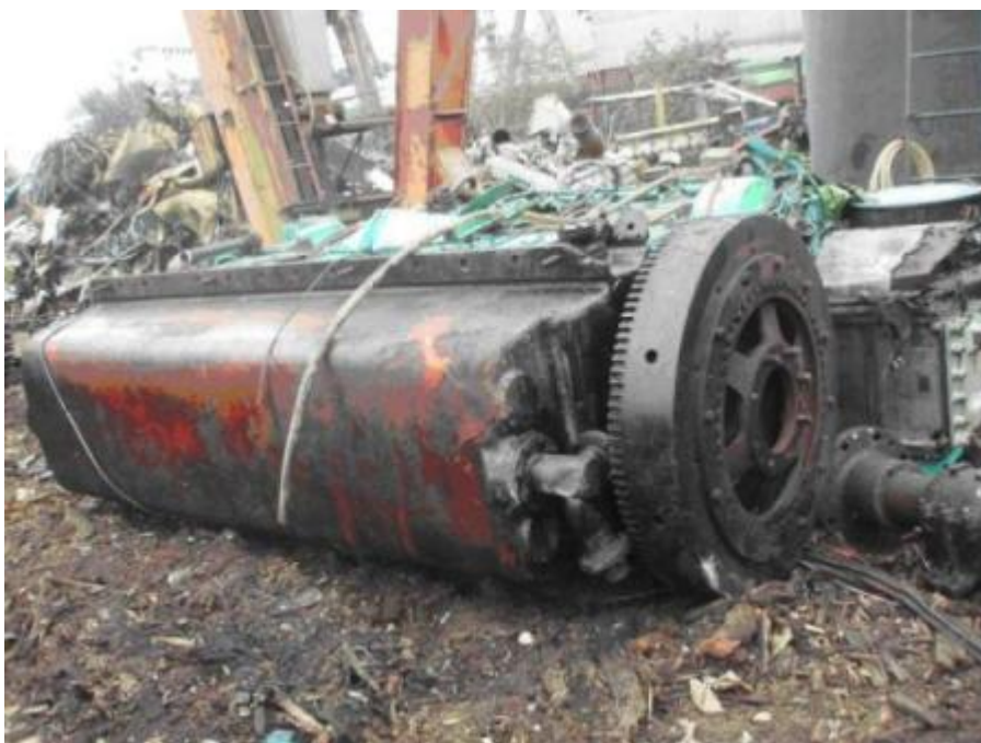
主機引擎曲軸切斷後
