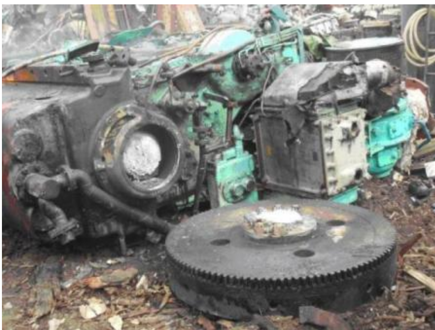
主機引擎曲軸切斷後
